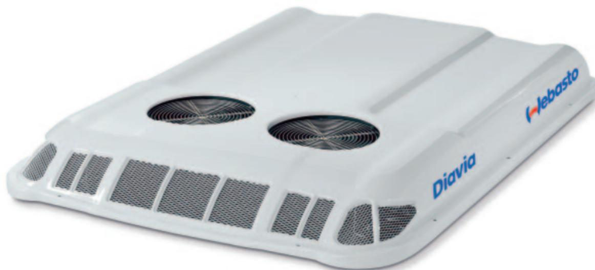
Estos equipos compactos de climatización de montaje en el techo se han dimensionado especialmente para refrigerar autobuses pequeños y medianos de hasta 35 plazas. Están dotados con potentes ventiladores que aseguran un flujo constante de aire y mejoran el rendimiento del equipo. Incorporan componentes de alta calidad lo que hace que estos aparatos sean muy fiables y duraderos.
